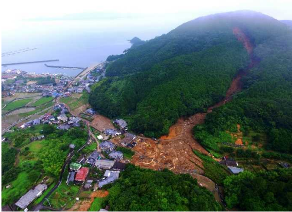
山腹崩壊 (津奈木町・平国 ひらくにしも 下地区)
